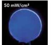
0,4-mm dickes Zirkonoxidplättchen mit Keramikschichtung bis zu 1,6 mm.
