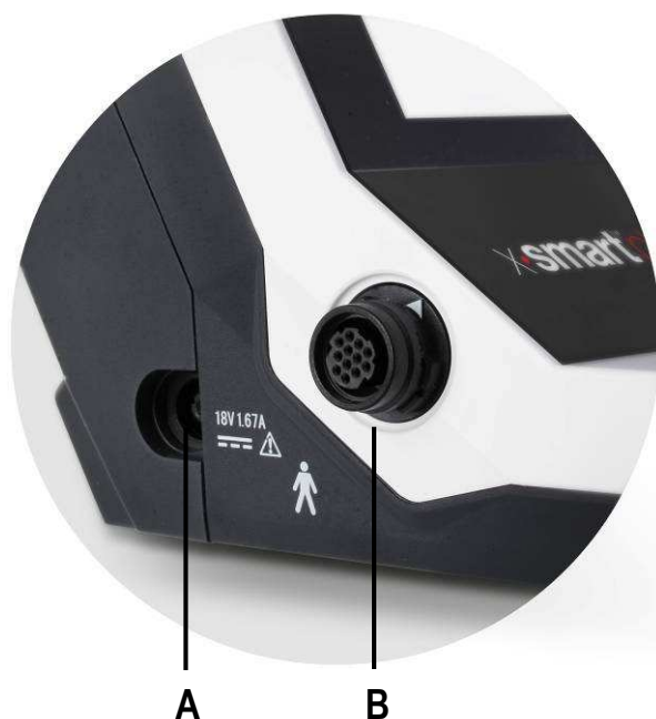
Fig. 4 Connettori alimentazione e manipolo del motore
